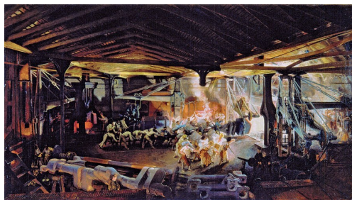
Forgeage au marteau-pilon dans les ateliers d'Indret de l'arbre coudé d'une frégate à hélice de 600 chevaux, huile sur toile de Bonhomme, 1865 (Écomusée du Creusot).
