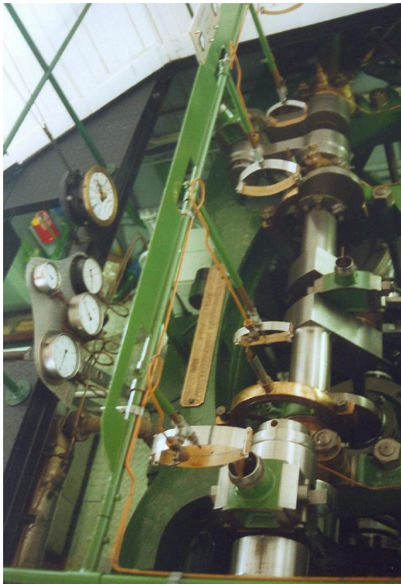
Vue générale de la machine du Gisela Au milieu la pompe à air et les excentriques de distribution, aux extrémités les cylindres Photo Gordon Stewart Paddle Stewart Lis
