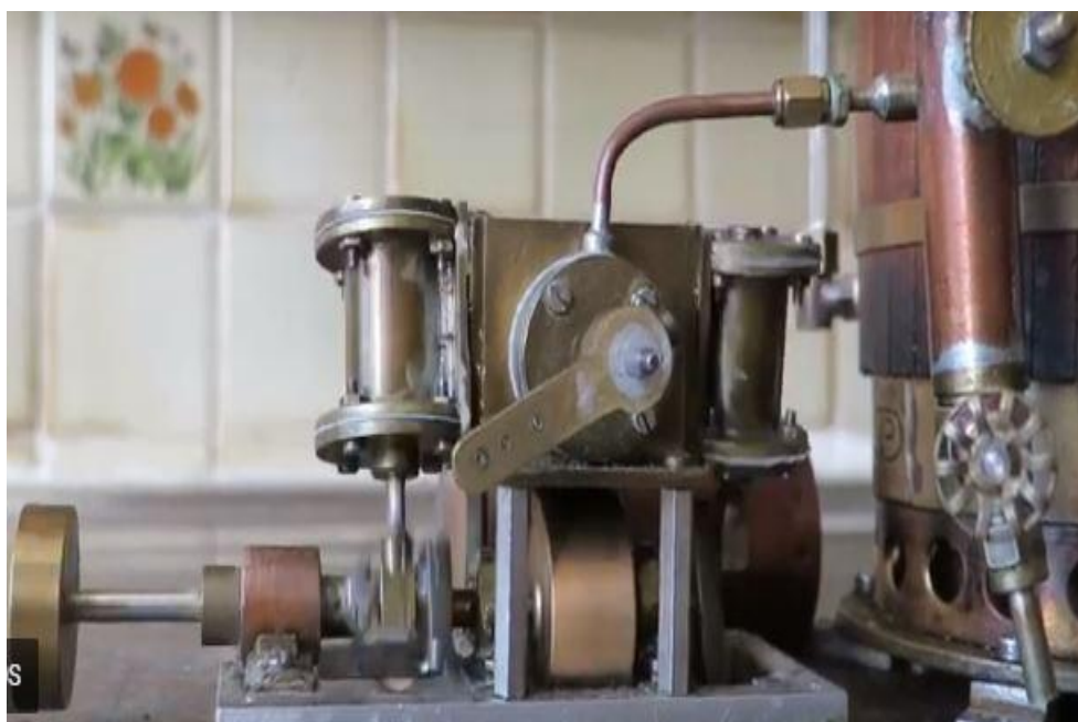
Moteur à vapeur miniature avec deux cylindres oscillants
